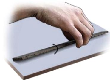
volado), con una velocidad constante, hasta que por su propio peso se rompa. No coger la probeta con la mano, sino recibirlas con la tabla de apoyo. Observar las dimensiones que tienen los trozos rotos y obtener una longitud (L) promedio.
