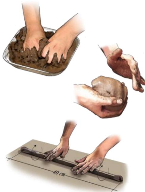
(humedecer previamente la lámina plástica para que se adhiera al molde). Colocar el rollo de barro en el canal del molde y presionarlo con la ayuda de los dedos. Retirar los sobrantes con la ayuda del cuchillo **(3)**. Luego proteger la cinta con la lámina plástica y presionarla con la tabla auxiliar **(16)** hasta formar una cinta perfectamente regular de 40 cm de largo, 2 cm de ancho y 0.5 cm de espesor.
